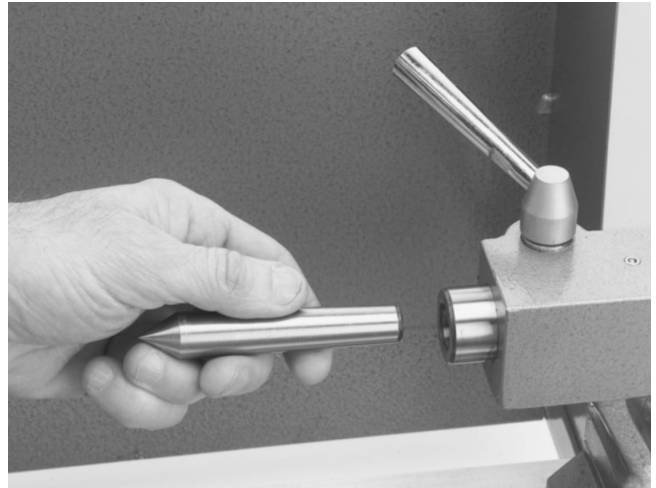
Kärjen asentaminen pinooliin
