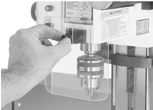
Fig. 3 Montering av øyevernsskjerm på fres/borehodet.
