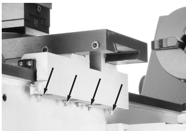
Skruer for føringslister bagtil på slæde
