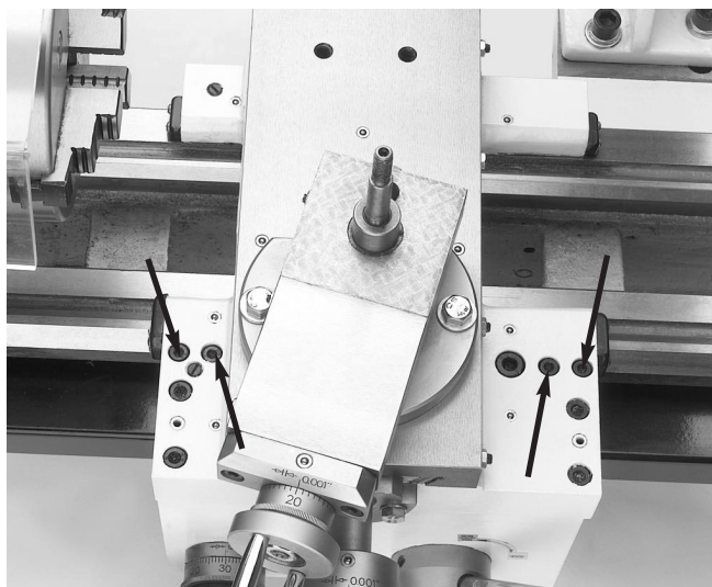
Skruer for føringslister fortil på slæde
