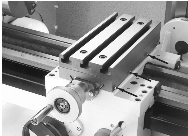
Skruer til føringsliste for tværslæde
