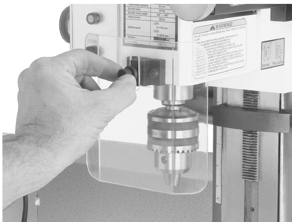
Fig. 3 Montering af øjenbeskyttelses skærm på fræse/borehovedet
