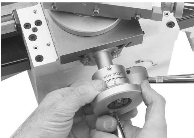
Indstilling af skala på håndhjul
