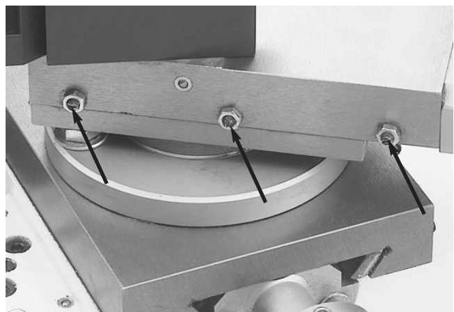
Skruer til føringsliste for forsætterslæde
