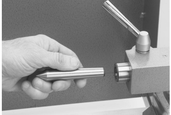
Indsætning af fast pinol i pinolrør
