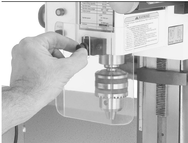
Kuva 3. Suojalasin kiinnittäminen jyrsin-/poralaitteeseen.
