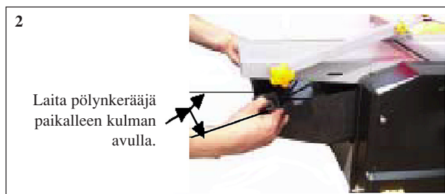
2. Laita pölynkerääjä paikalleen oikohöylän työpöydän alapuolelta kulman avulla.
