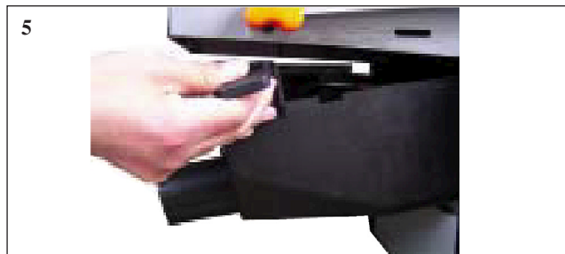
5. Putekļu pārsegam jābūt novietotam tā, lai 2 ķīļi abās pusēs atbilstu 2 atverēm abās galda pusēs.
