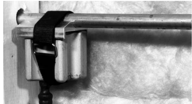
Şekil 7 – Velcro Bantla Bağlanmış Uç Adaptörlü Dondurma Kafası
