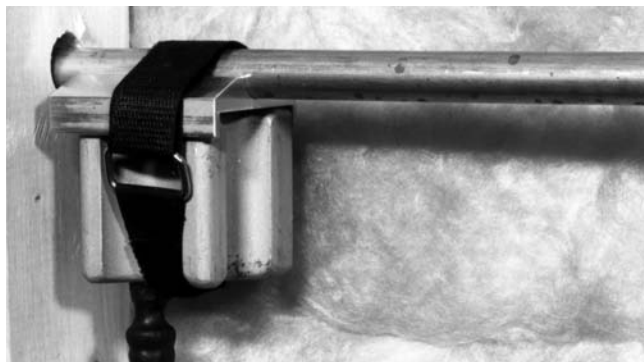
Рис. 7 – Замораживающая головка с концевым переходником, прикрепленная с помощью фиксирующего ремня с застежкой "липучка"
