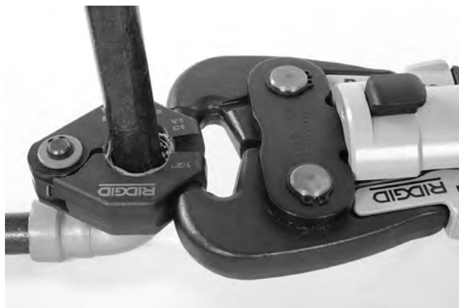
Slika 12 – Pritrjevanje sprožila na obroč za stiskanje
