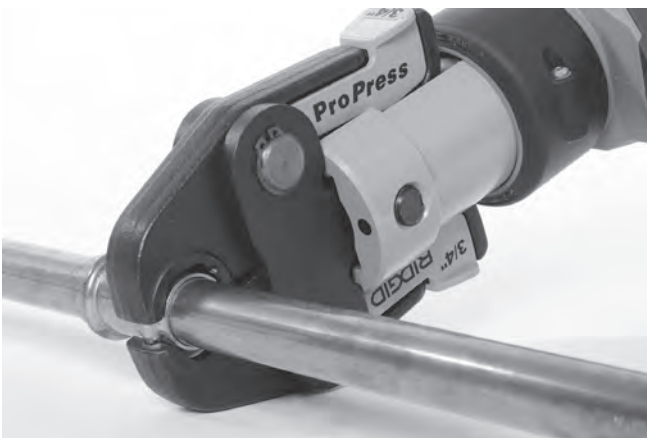
Figur 9 – Placera käftar av saxstil runt beslaget
