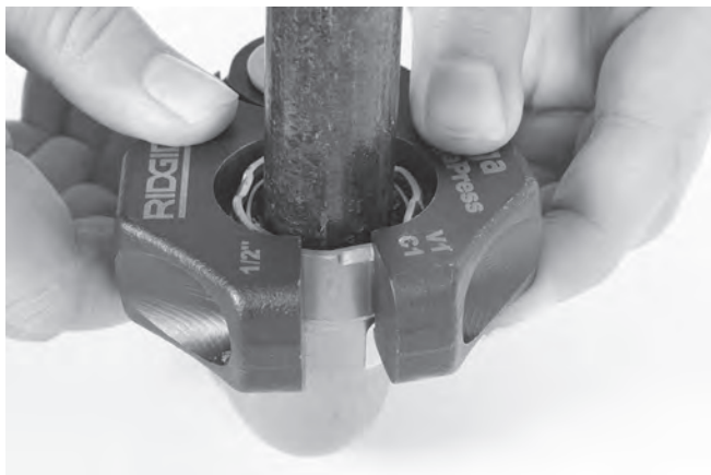
Figure 11 - Installazione dell'anello di pressatura sul raccordo
