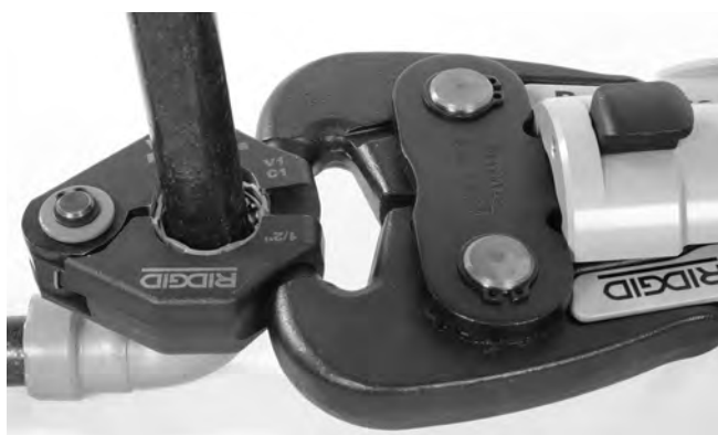
Figura 12 – Montaje del accionador en el aro sellador
