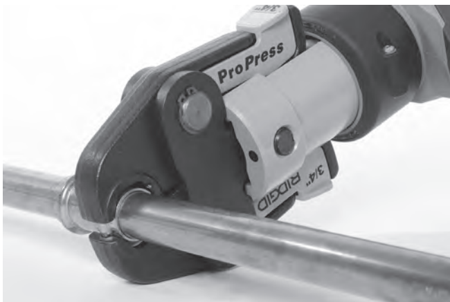
Figur 9 – Plassering av pressbakkene rundt presskoblingen
