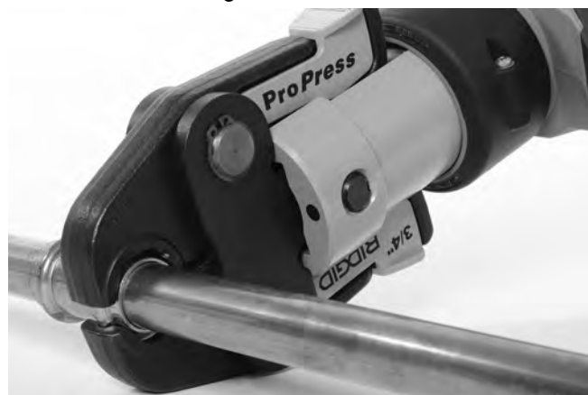
Figura 9 – Colocación de las mordazas tipo tijera para que encierren el acoplamiento
