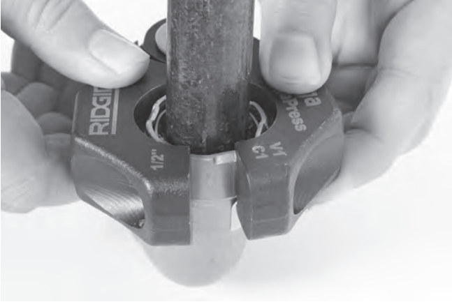
Şekil 11 – Pres Halkasının Tespit Elemanının Üzerine Takılması
