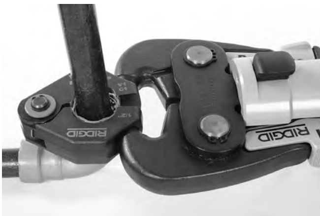
Slika 12 – Pričvršćivanje aktuatora na prsten za prešanje
