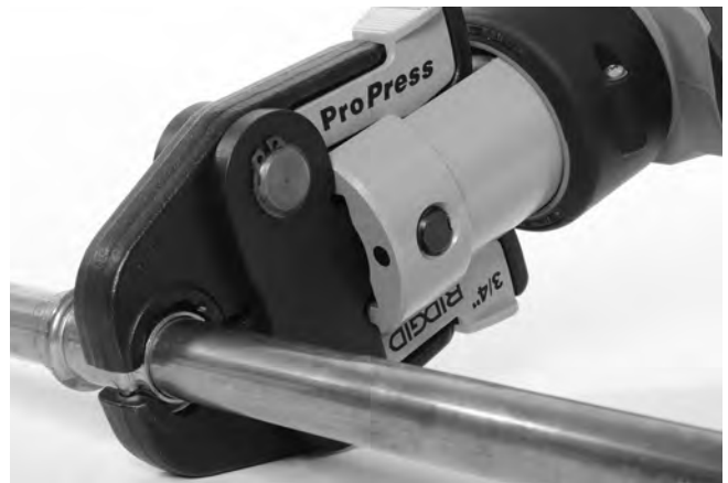
Figure 9 – Engagement des mâchoires à cisaille autour du raccord
