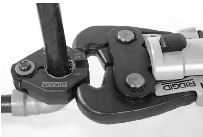
Slika 12 – Postavljanje aktuatora na prstenastu presu
