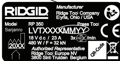
Kuva 3 – Koneen sarjanumero - Ympyröidyt numerot osoittavat valmistusvuoden ja -kuukauden. (YY = vuosi, MM = kuukausi).
