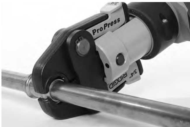
9. ábra - A szerelvény körülzárása ollós pofákkal
