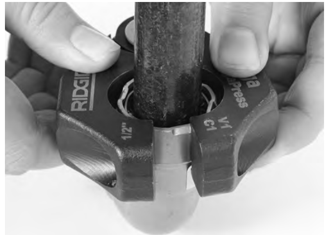
Figura 11 – Montaje del aro sellador en el acoplamiento
