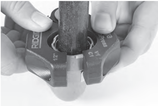
Figur 11 – Sätta dit pressringen på beslaget
