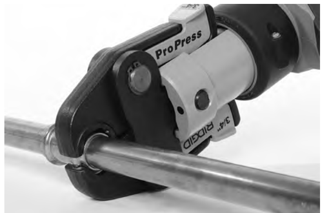
Рис. 9 – Установка пресс-клещей ножничного типа вокруг фитинга
