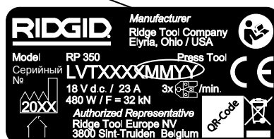
Рис. 3 - Серийный номер машины - Цифры в кружке обозначают год и месяц изготовления. (YY = год, MM = месяц).
