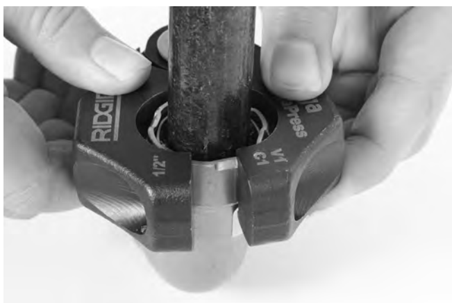
Slika 11 – Postavljanje prstenaste prese oko priključka
