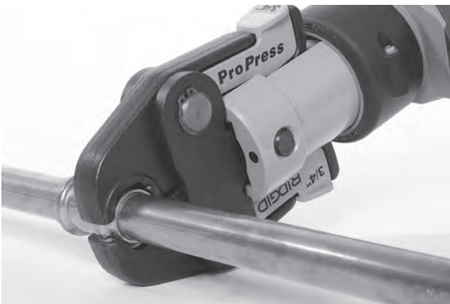
9-сурет – Қайшы тәрізді қармауыштарды фитинг айналасына орналастыру
