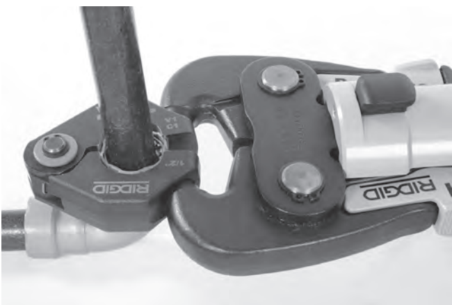
Figur 12 – Fästa aktuatoren på pressringen
