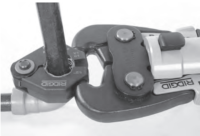
Kuva 12 – Käyttölaitteen kiinnittäminen puristusrenkaaseen
