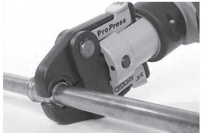
Figura 9 - Collocamento di ganasce di stile a forbice intorno al raccordo
