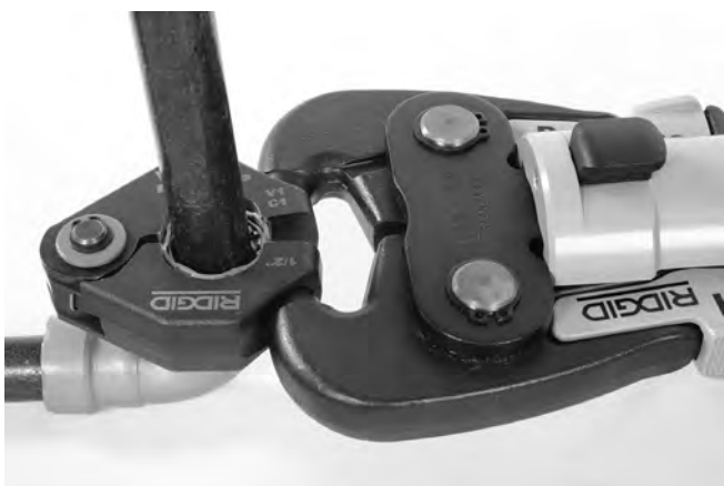
Рис. 12 – Крепление рабочей насадки на обжимном кольце
