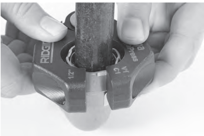
Abbildung 11 – Anbringen des Pressrings am Fitting
