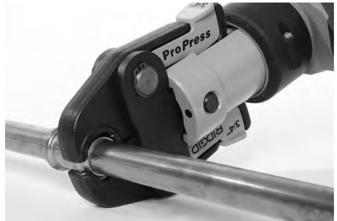
Slika 9 – Nameščanje škarjastih čeljusti okoli nastavka
