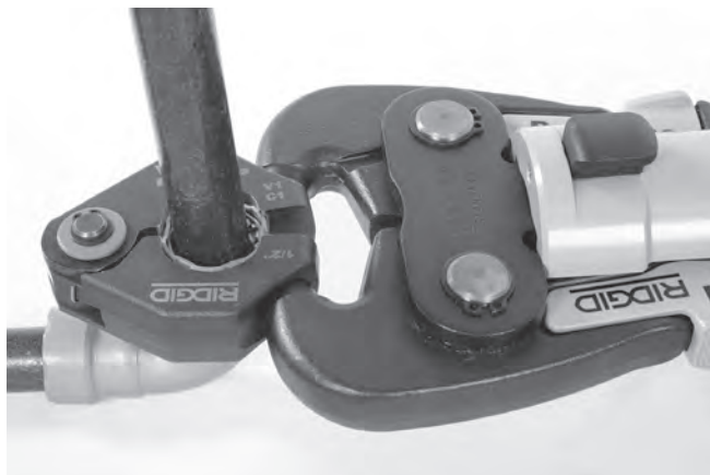
Figur 12 – Feste aktuatoren til pressringen
