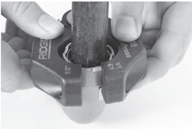
Figuur 11 – Aanbrengen van de persring op de fitting
