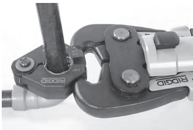
Abbildung 12 – Ansetzen des Stellantriebs am Pressring
