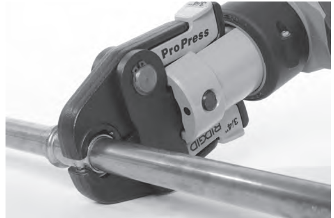
Figura 9 – Așezarea fălcilor tip foarfece în jurul fittingului
