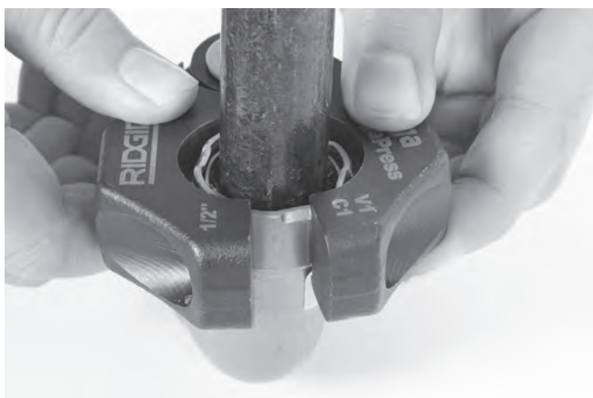
Figura 11 – Instalar o Anel de Prensagem no Engaste
