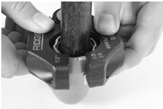
Slika 11 – Nameščanje obroča za stiskanje na nastavek
