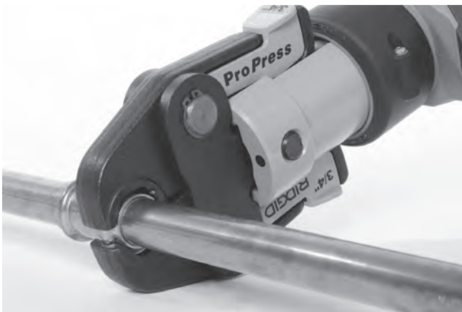
Obrázek 9 – Umístění nůžkových čelistí kolem armatury
